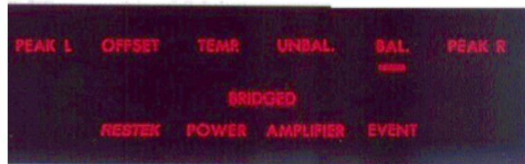
Das große Display der Endstufe informiert über ihren Betriebszustand und macht auf Störungen aufmerksam
