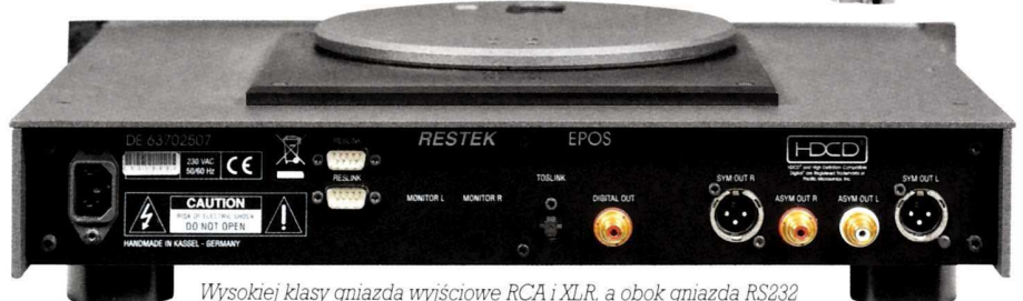
Wysokiej klasy gniazda wyjściowe RCA i XLR, a obok gniazda RS232 systemu zdalnego sterowania Reslink.
