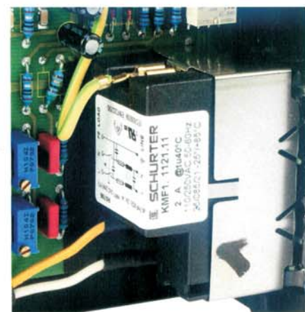
Netzbuchse mit Schalter, Sicherungen und eingebauter Hochfrequenzsperre
