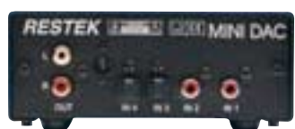
Restek „MiniDac“: Zum Anschluß von je zwei digitalen Signalquellen über TosLink und Coax, Formate von 32–96 kHz Abtastrate und 16–24 bit werden automatisch erkannt und in ein analoges Signal umgewandelt.
