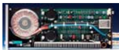
Restek „MiniAmp“: Mono Endstufe mit Sinusdauerleistung von 70 W an 4 Ohm und mehr als 100 W Impulsleistung
