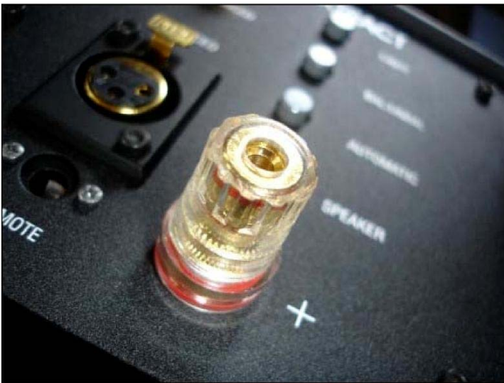
Hervorragende Lautsprecherkabel-Anschluss terminals mit exzellenter Eignung auch für hochwertige Bananenstecker.
