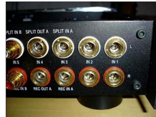
Hommage an die Profitechnik: Mini-XLR-Terminals in dreipoliger Ausführung
