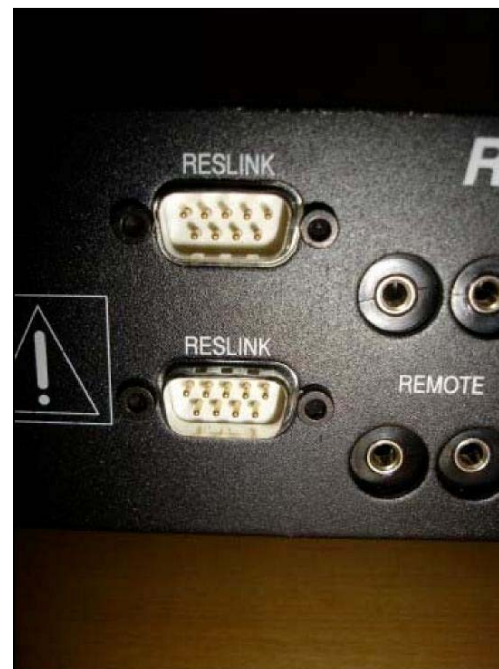
Reslink-Anschlüsse zur Geräteverbindung aktueller Restek-Komponenten.
